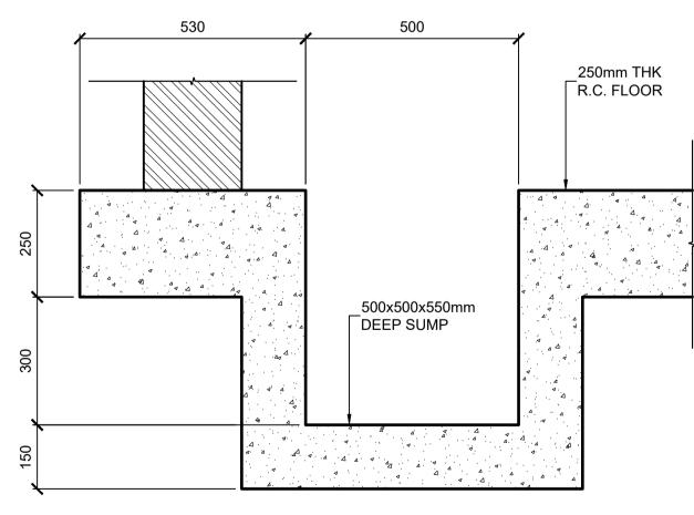
TYPICAL SUMP DETAIL SCALE 1:10
