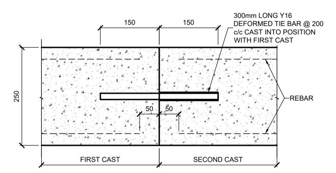
**CONSTRUCTION JOINT DETAIL**
